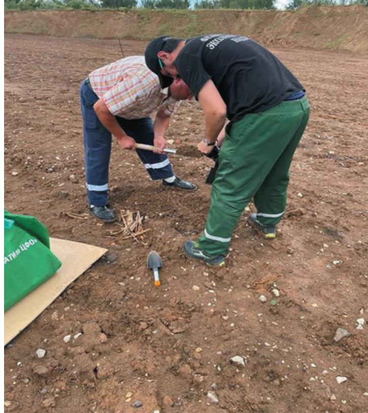
Рис. 2. Отбор проб грунтов на технологической площадке
